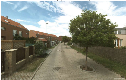
příklad uličního prostoru řešeného z částí pomocí zatravněné plochy pro vsakování dešťových vod (Holandsko)
